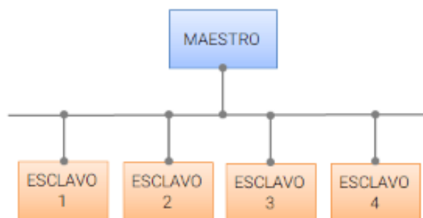
Figura 10-1. Esquema de comunicación con MODBUS.
